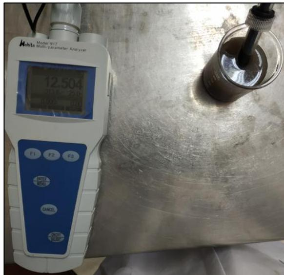
**Figura °N 9 Determinación de pH y Temperatura con el Multiparámetro**
