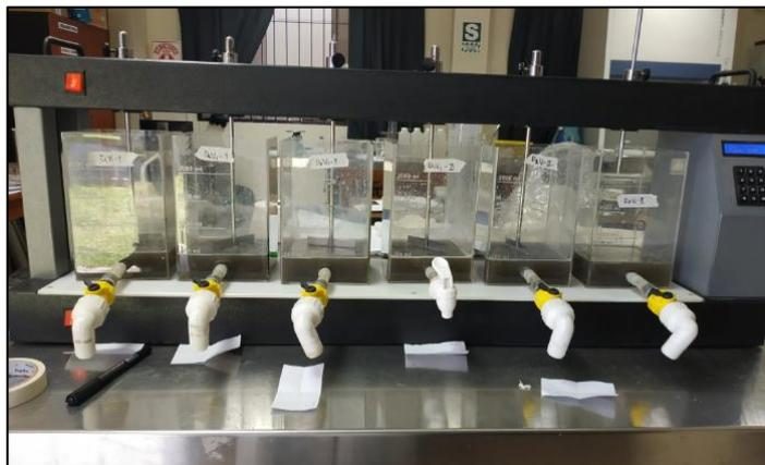
**Figura °N 10 Test de jarras en etapa de agitación rápida**
