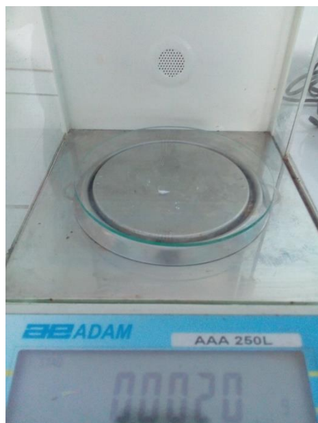
Imagen 03: Balanza analítica para pesar por separado de estándar de ibuprofeno, pastilla de ibuprofeno y dióxido de titanio.
