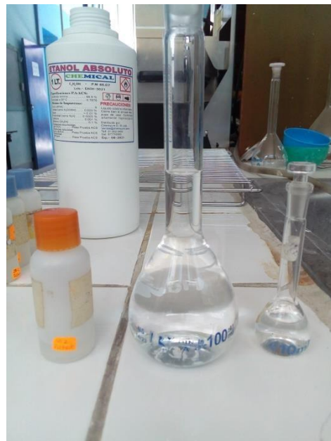
Imagen 16: Dilución del raspado en etanol
