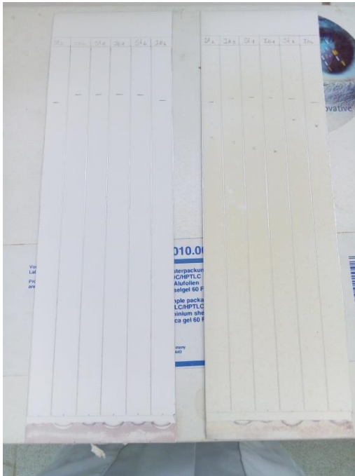
Imagen 13: (a) Placa lado izquierdo sin el revelado; y, (b) placa lado derecho con el revelado
