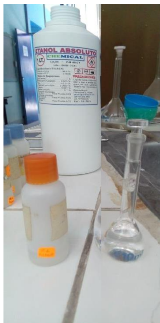
Imagen 17: Dilución de 0.1 mL de la muestra en etanol en una fiolita de 10 mL
