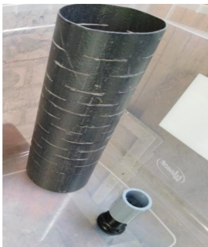
Figura 11. Tubo PVC de 4' de diámetro x 25 cm de altura con aberturas para evitar el paso de sólidos
