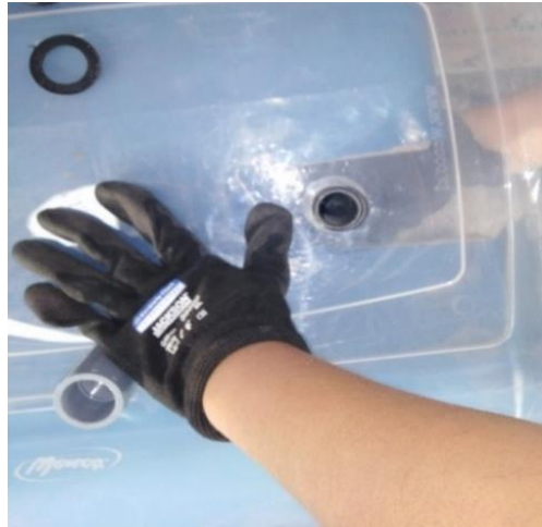
Figura 9. Perforación de la base de la cama de cultivo para el drenaje de agua
