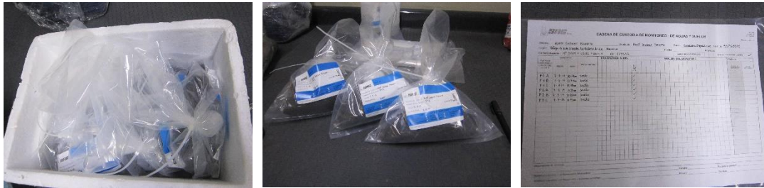
Figura 19. Muestras y cadena de custodia para análisis de carbono orgánico total por Walkley & Black
