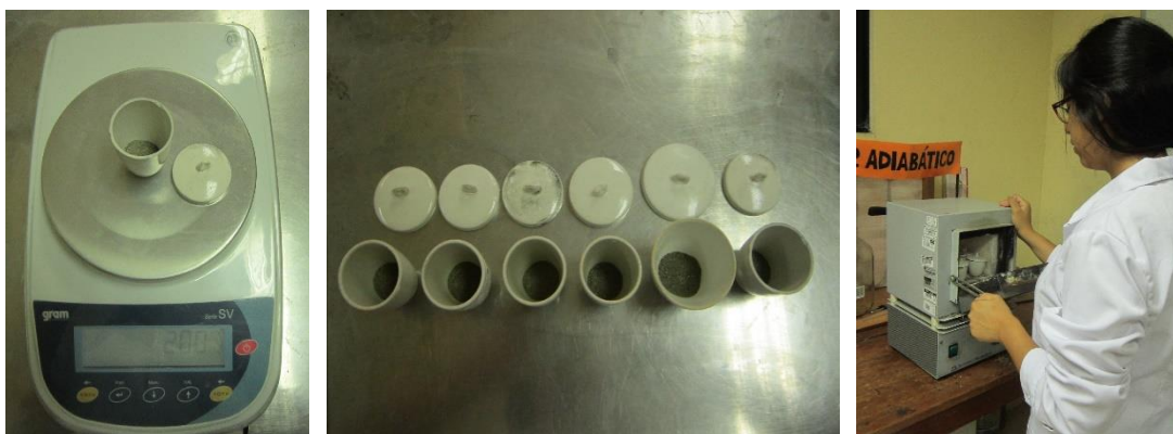
Figura 15. Estimación del factor de carbono en el suelo por el método de %LOI
