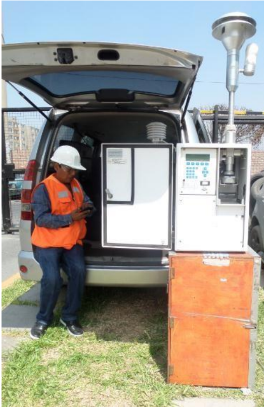
Instalación del equipo (Partisol 2000)
