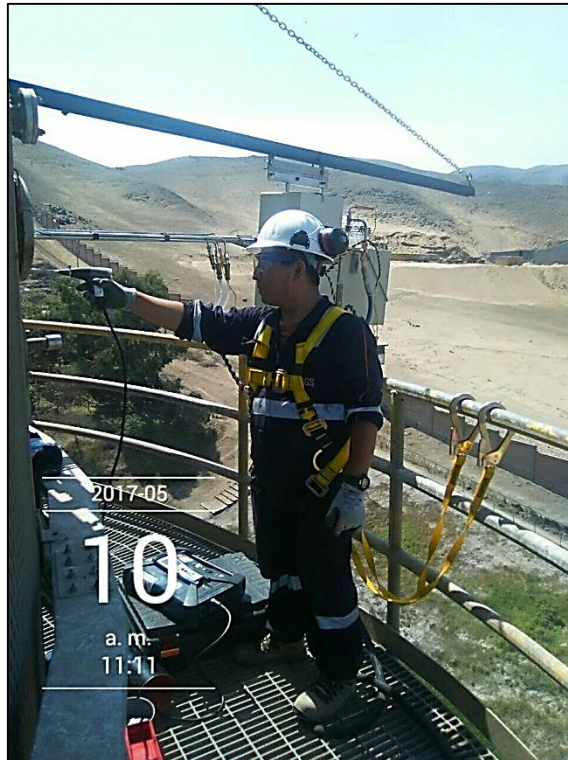
Figura 25. Monitoreo simultaneo de emisiones con el equipo isocinético y analizador automático de gases (TESTO 350) (Fuente: Elaboración propia)
