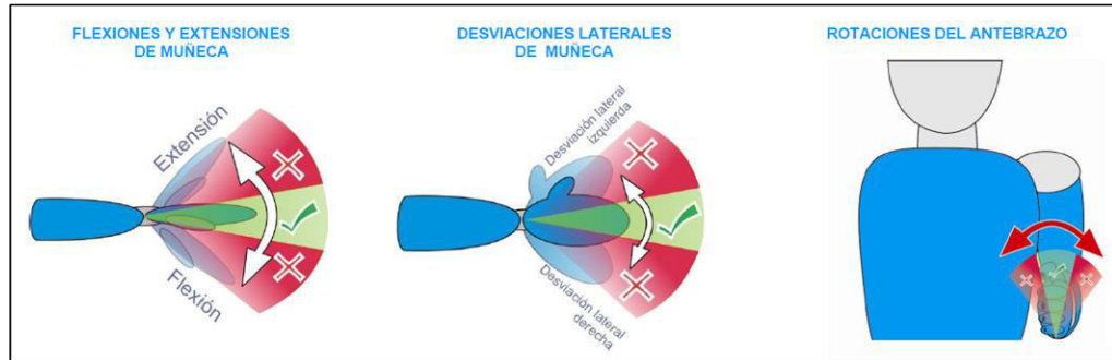
Figura N° 31: Rango de movimientos aceptables del antebrazo, muñeca y mano Fuente: Universidad Politécnica de Cataluña, 2015
