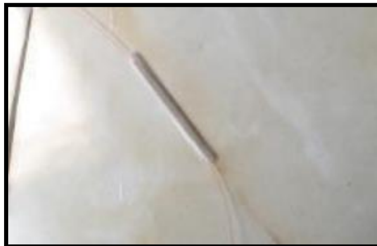
Figura 56. Fibra con protector de empalme termo contraíble.
