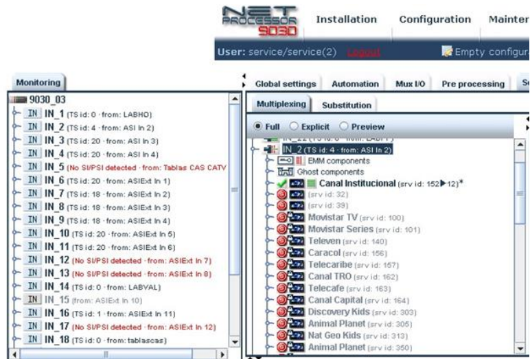
Figura 39 Multiplexación de servicios.
