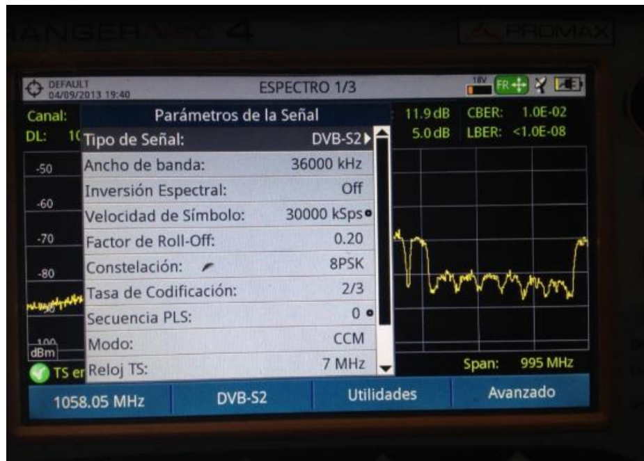
Figura 56 parámetros de una señal HD
