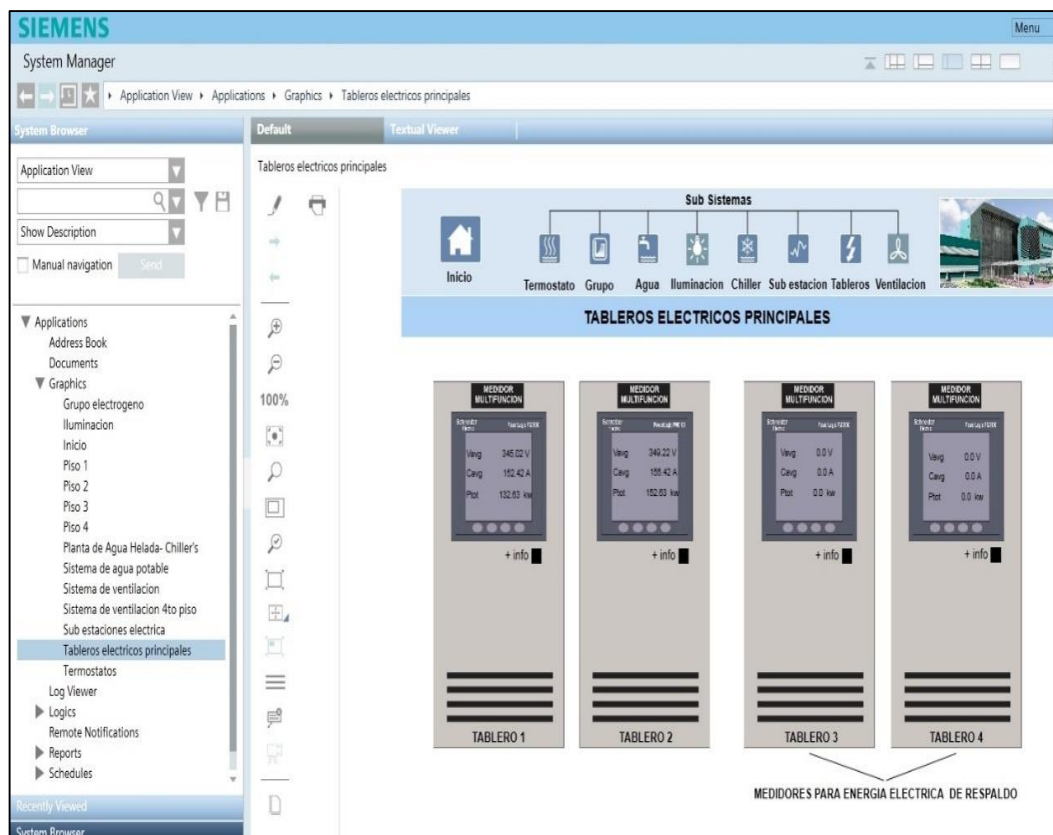
Figura 39. Pantalla de tableros principales de energía. Fuente: Elaboración propia.
