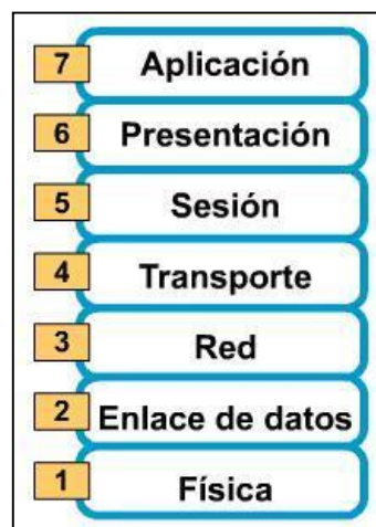
Figura 4 Capas del modelo OSI
