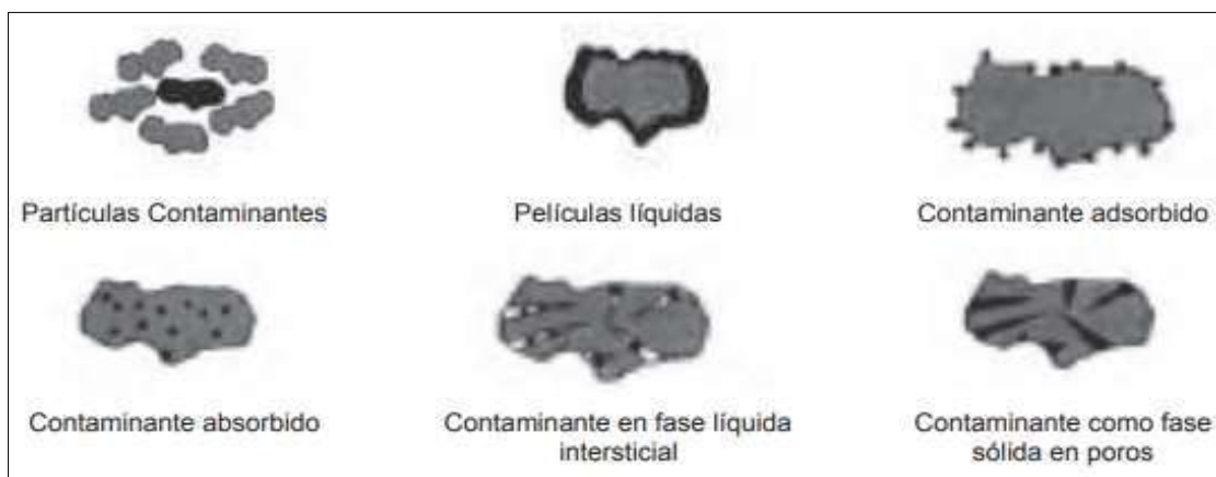
Figura 7. Estado físico de los contaminantes en terrenos y sedimentos
