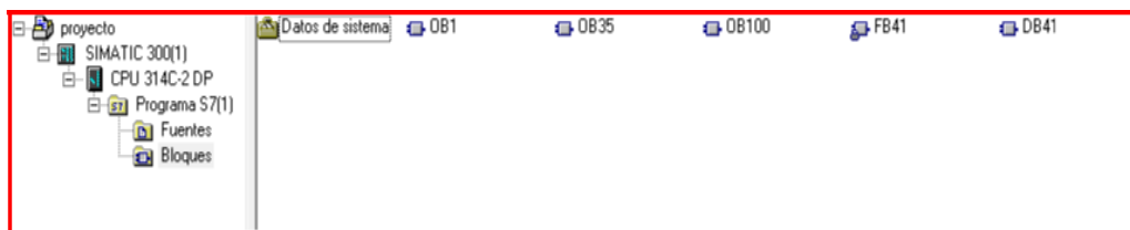
Figura 28: Bloques de organización en SIMATIC STEP 7
