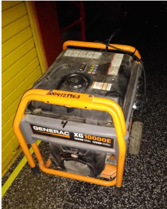
Figura 31: Grupo electrógeno XG10000E Fuente: Elaboración propia
