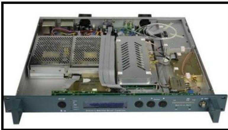
Figura N° 42: Trasmisor óptico 1550 nm del proveedor Optictimes
