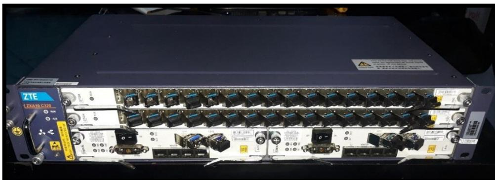
Figura N° 41: OLT del proveedor ZTE modelo ZXA10 C320
