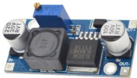
Figura14: Modulo STEP UP XL6009. Fuente: www.pixelelectric.com
