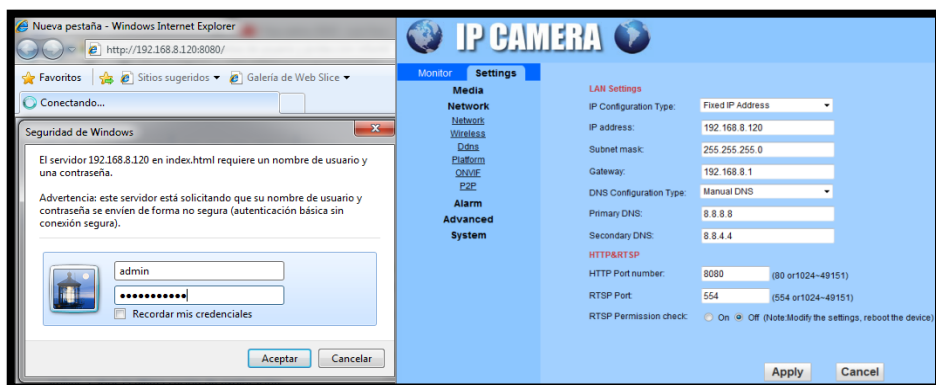
Figura 58: Parámetros de configuración en la cámara IP
