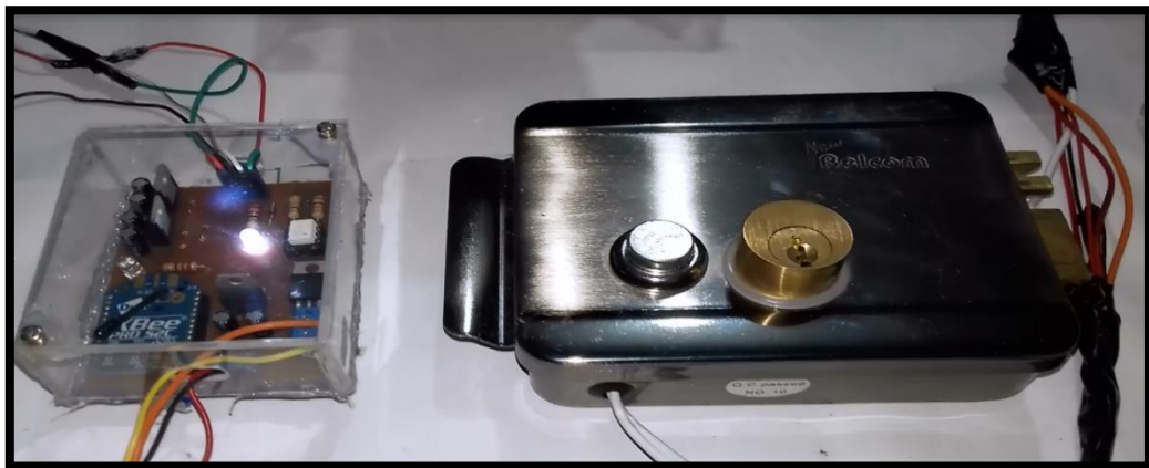
Figura 76: Activación de la cerradura eléctrica en el tercer escenario
