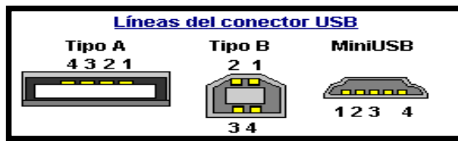
Figura 30: Líneas eléctricas del conector USB 1.0 y USB 2.0
