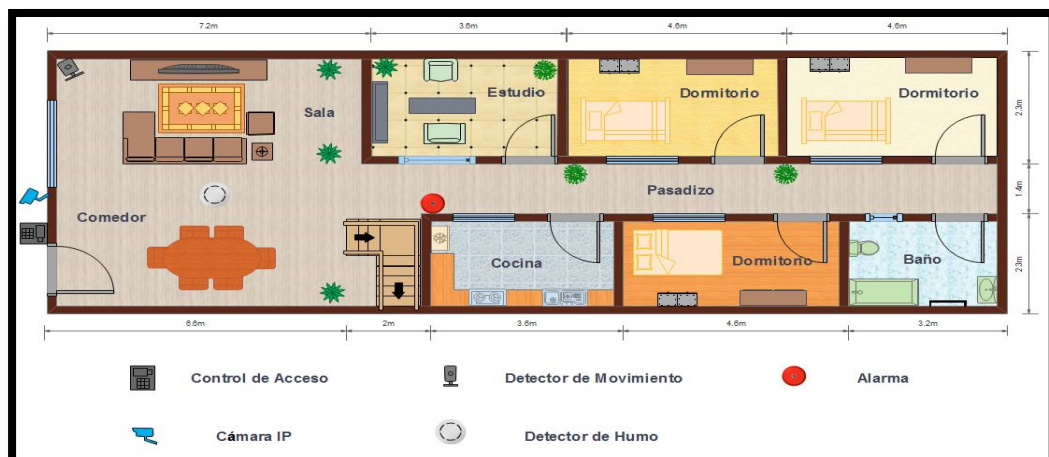
Figura 36: Plano de la vivienda con la ubicación de los dispositivos
