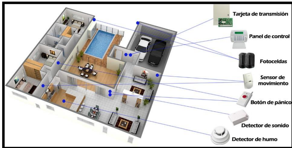
Figura 20: Sistema de Seguridad
