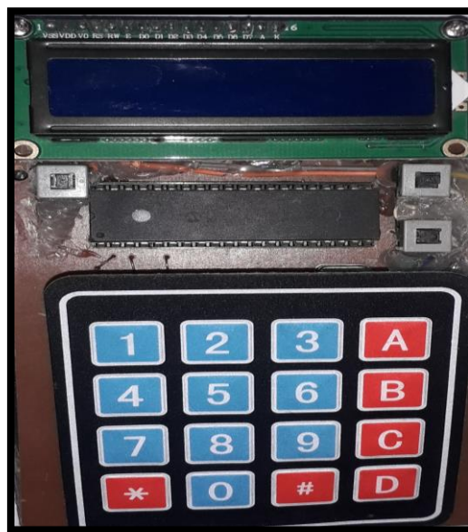
Figura 47: Tarjeta de control de acceso 1
