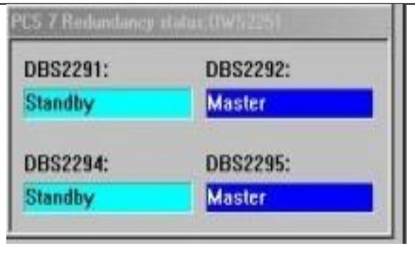
Es recomendable empezar la descarga por el servidor que trabaja como StandBy. En este caso el servidor DBS2291. Ubicamos el servidor mediante la combinación de las teclas y cerramos el RUNTIME y reiniciamos la PC del servidor.
