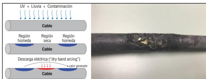
Figura 20. Cable óptico degradado por el efecto Tracking.
