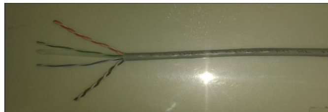
Figura 34. Cable F/UTP Elaboración propia
