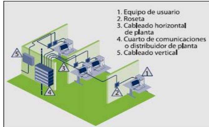
Figura 1. Elementos del cableado estructurado
