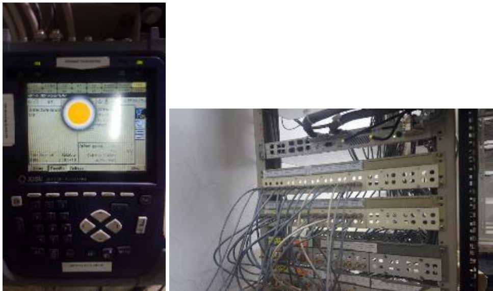
Figura 37 - Medida de BER usando loops para conectar los conectores para E1 en cascada.
