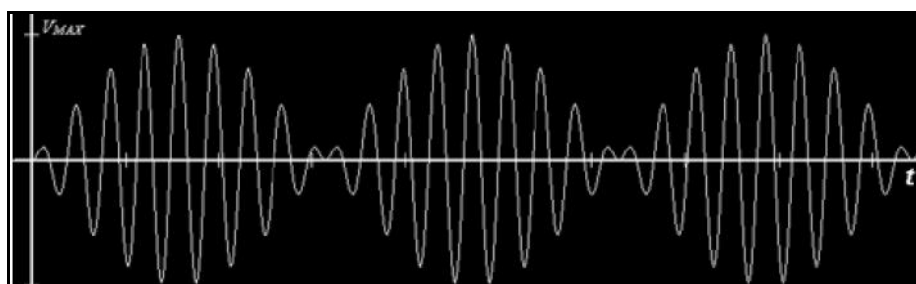
Figura 3.4 Forma de onda de una bobina de Tesla
