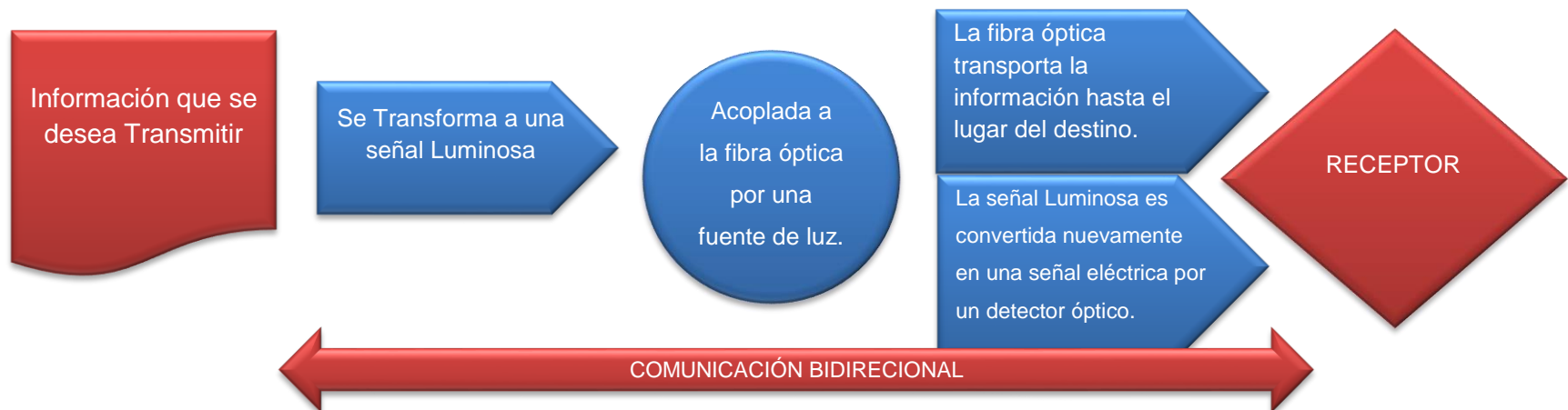
Figura 2.2. Diagrama de la Comunicación por Fibra Óptica. Fuente: Elaboración Propia.
