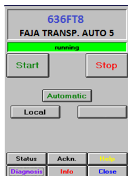
Figura 3.5. Ventana de comando de motores de fajas
