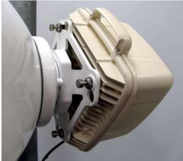
Figura 3. 4: ODU montada al herraje de montaje Andrew
