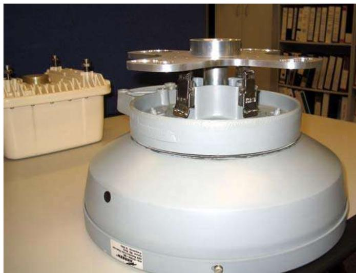
Figura 3. 3: Placa adaptadora colocada en la antena XP4
