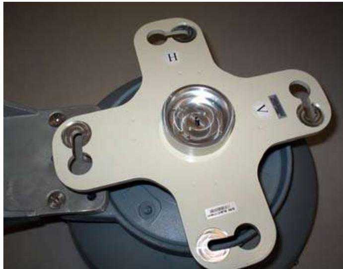
Figura 3. 2: Placa adaptadora para la antena XP4
