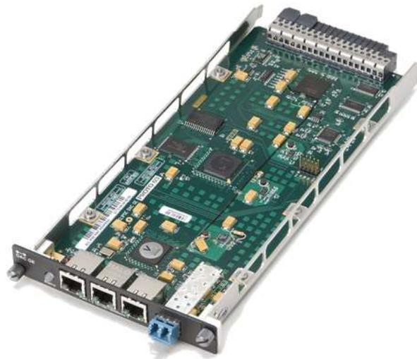
Figura 2 14: Tarjeta de Acceso de Datos (DAC GE)
