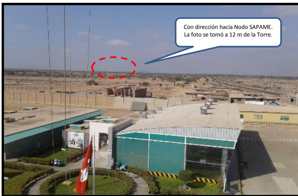
Figura 3.22. Línea de vista (LOS) hacia ATC Sapame.
