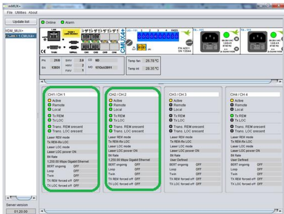
Figura 3.22 Equipo CMUX está operativo en funcionamiento de Canal 1y2.
