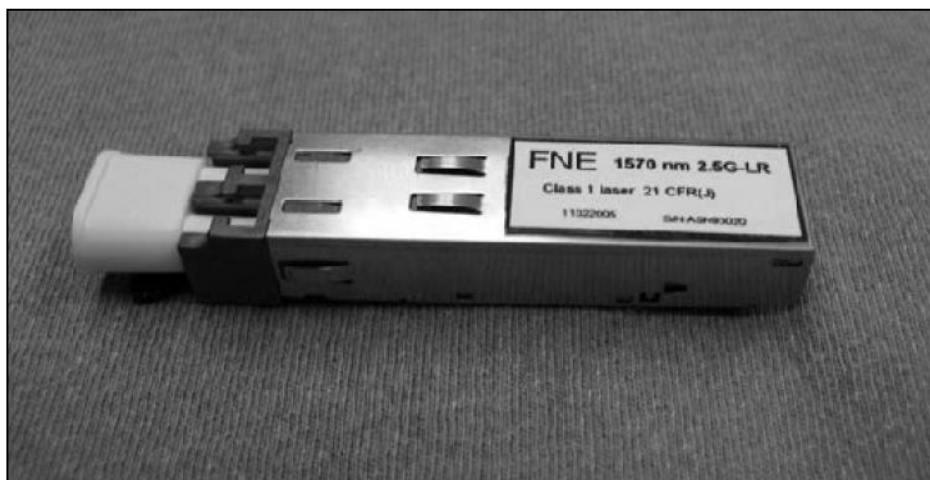
Figura 2.32 /Transceiver SFP para longitud de onda de 1570nm CWDM.
