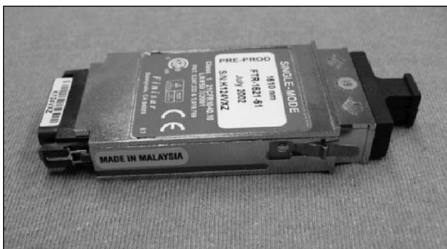
Figura 2.31 / Un transceiver GBIC para longitud de onda CWDM de 1610nm
