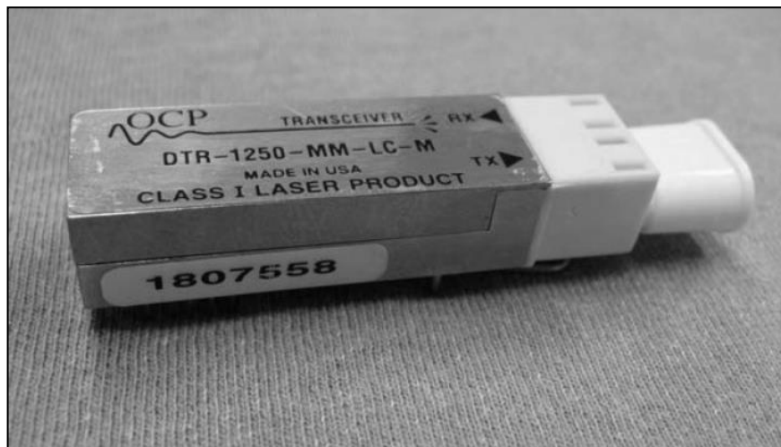
Figura 2.30 / Un transceiver SFF.
