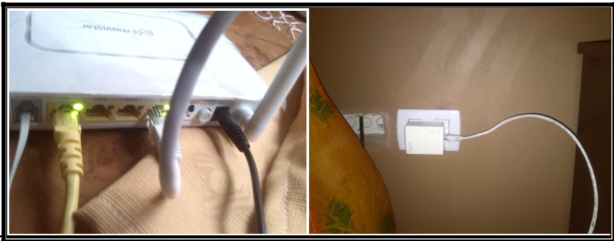
Figura: 16: Inyección de la señal de internet en la línea eléctrica desde el router.
