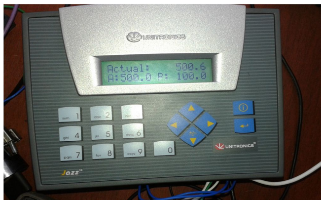
Figura 3. 28. Prueba de cambio de rangos de presión diferencial
