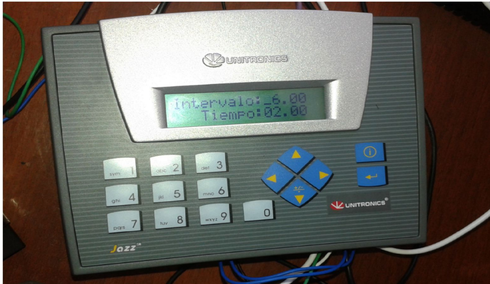
Figura 3. 30. . Prueba modificación de tiempos intervalo y permanencia
