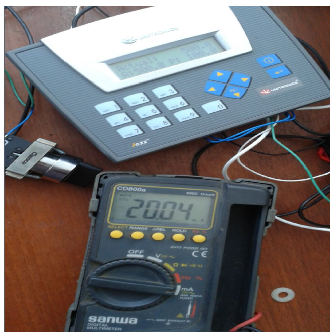
Figura 3. 29. Prueba generando corriente de 20mA
