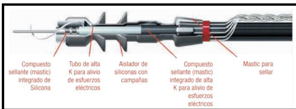
Figura 54: Terminación exterior tipo corto 7692-S-4 (3M)
