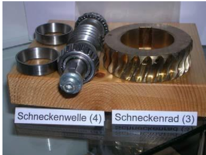
Figura 19. Eje Tipo Sin fin y Corona de Bronce.
