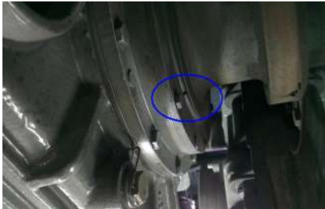
Figura 7: Agujeros de purga del reductor
