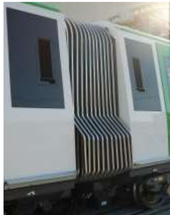
Figura 31: Pasillo de intercirculación exterior
