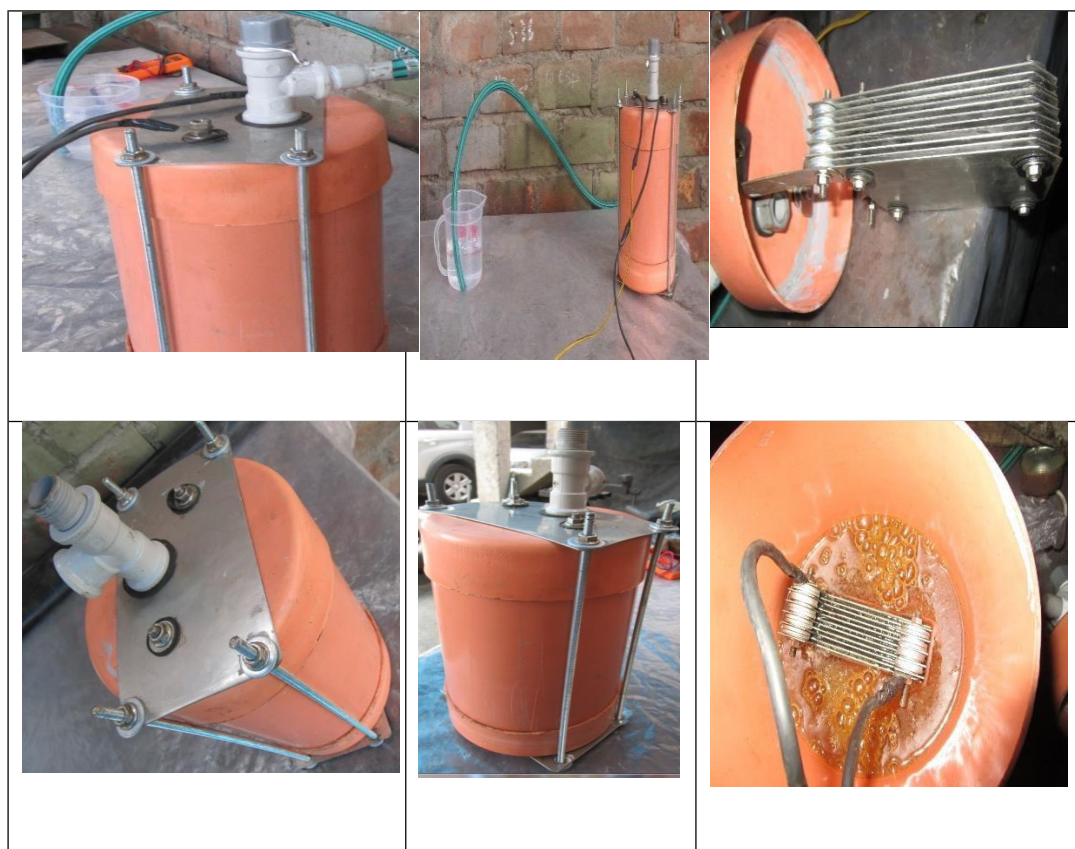
Figura 25. Generador de hidrogeno
