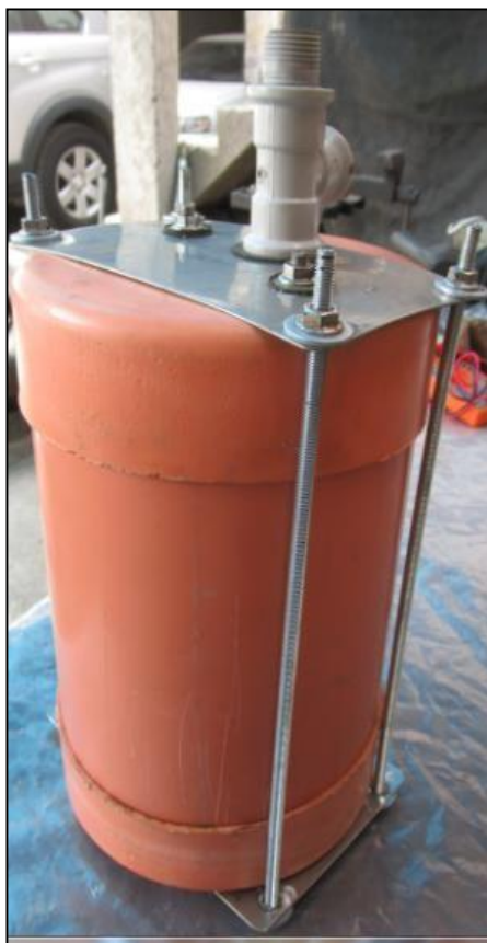
Figura 22. Generador de hidrogeno
