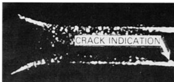
Figura 2.8 Una pequeña indicación de grieta en una biela que está enmascarada por un excesivo ruido visual de fondo [5].
