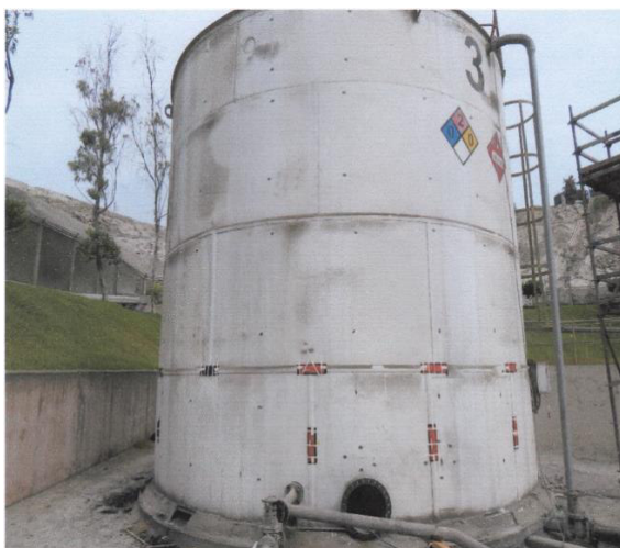
Figura 4.9 Distribución de placas radiográficas
