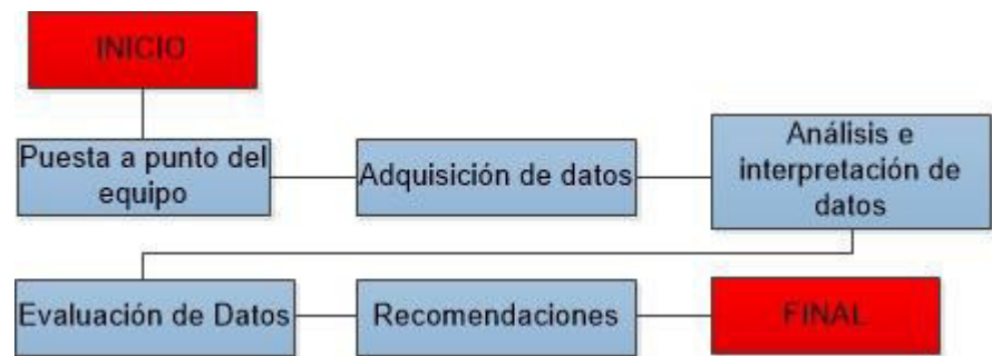
Figura 2.17 Proceso de aplicación de AET (Fuente propia)
