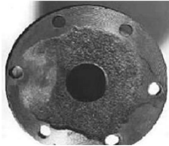
Figura 3.7 Corrosión por Rendijas o Crevice [7]
