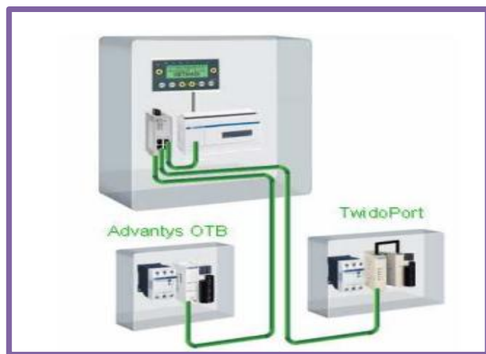
FIGURA Nº 07: EJEMPLO DE ARQUITECTURA ETHERNET
