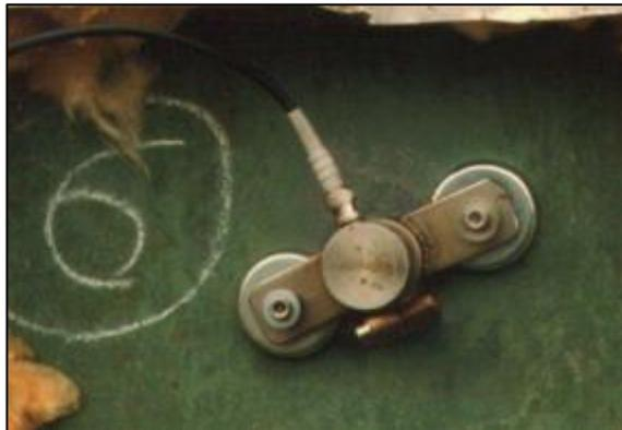
**Figura 2.53 – Sensor con soporte magnético**
