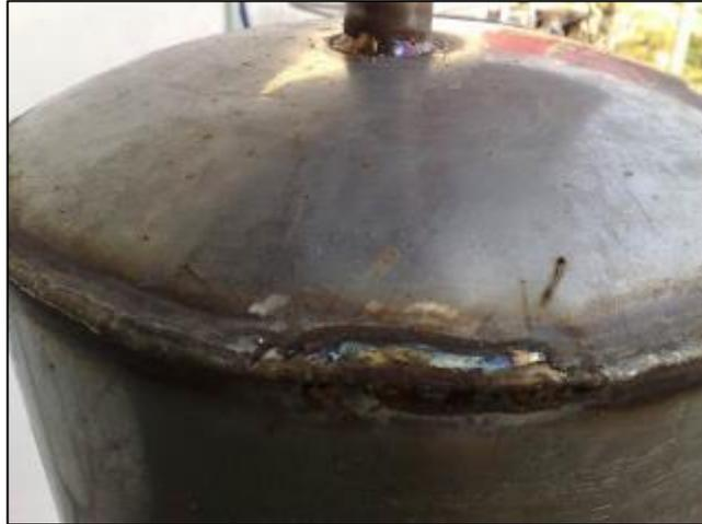
**Figura 2.5 – Socavaciones en cordón de soldadura**
