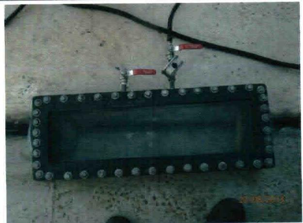
**FOTO N°04:** En la fotografía se observa el preciso instante de realización de ensayo de fuga por nuestro personal NDT.
