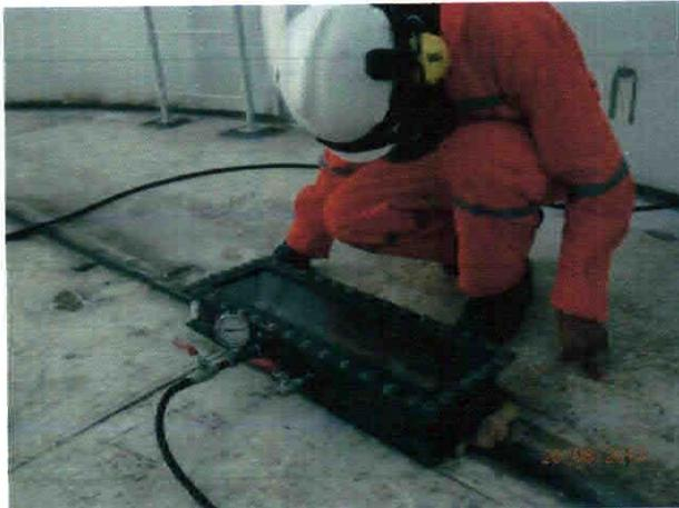
**FOTO N°01:** En la fotografía se observa el preciso instante donde los examinadores está observando posibles fugas en el momento de la Prueba de Fuga.
