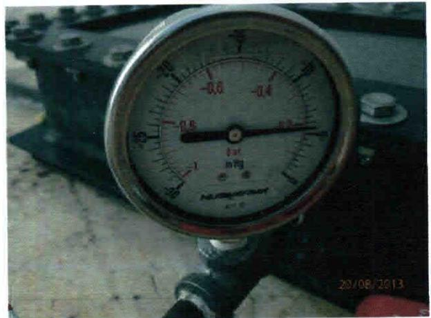
**FOTO N°02:** En la fotografía se observa en el vacuometro una presión de 21 kPa (2/6 pulg. Hg) a 35 kPa (2/10 pulg. Hg).
