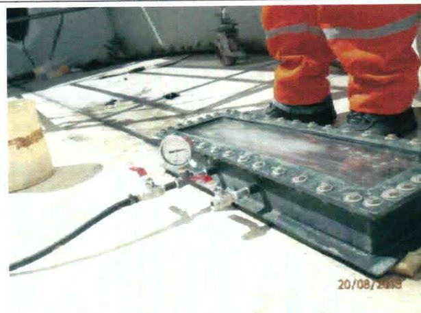
**FOTO N°03:** En la fotografía se observa el preciso instante de aplicación de presión a caja de vacío por nuestro personal NDT.
