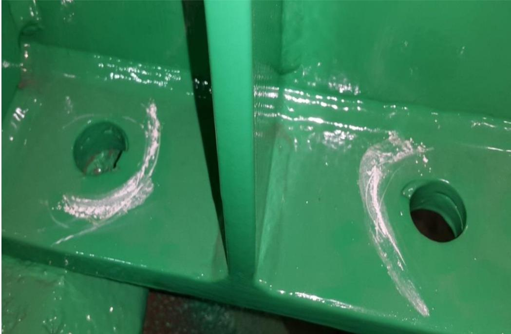
Elemento con falta de fusión en el cordón de soldadura (ver tabla 8).
