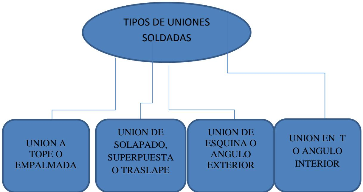
*Figura 2:* Clasificación de tipos de juntas
