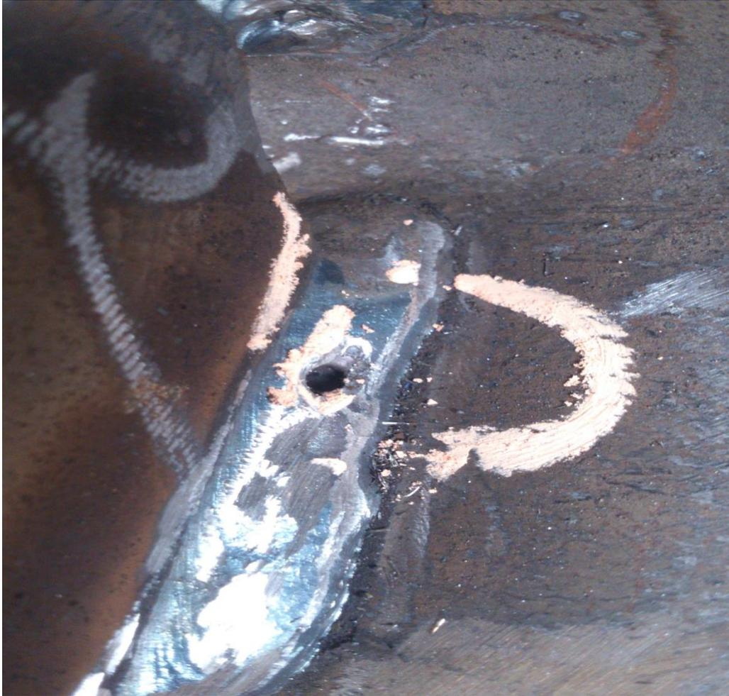
*Figura 33:* Defecto de soldadura en enrejado
