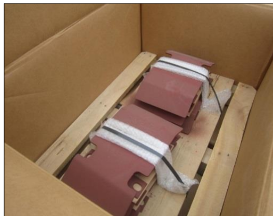
Figura 9: Deflector de cámara de espuma
