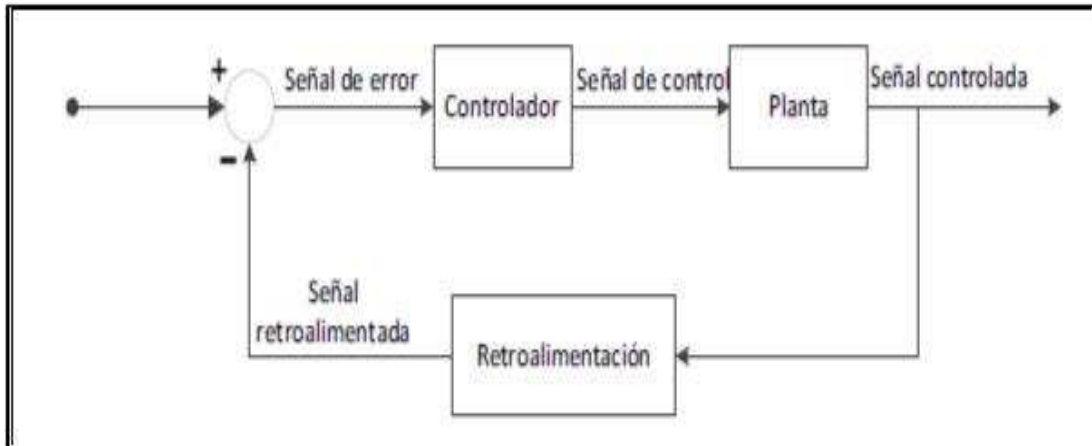
FIGURA N° 07: SISTEMA DE CONTROL DE LAZO CERRADO
