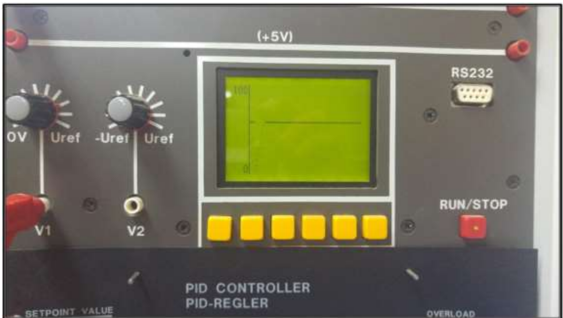
FIGURA N° 29: EL CONTROLADOR PID BUSCA QUE EL PROCESO CONSIGA ESTABILIDAD, ES DECIR REDUCE EL ESTADO TRANSITORIO Y AUMENTA EL ESTADO ESTACIONARIO
