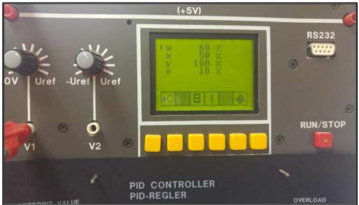
FIGURA N° 27: EL CONTROL PID MUESTRA LOS NIVELES DE VALOR DESEADO, VALOR MEDIDO, NIVEL MÁXIMO Y PORCENTAJE DE ERROR – 10%
