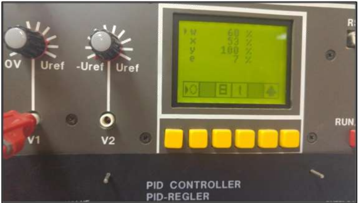
FIGURA N° 28: EL CONTROLADOR PID DETECTA LA VARIACIÓN Y DE INMEDIATO ENVIA UNA SEÑAL AL ACTUADOR PARA CONSEGUIR REDUCIR EL ERROR – 7%
