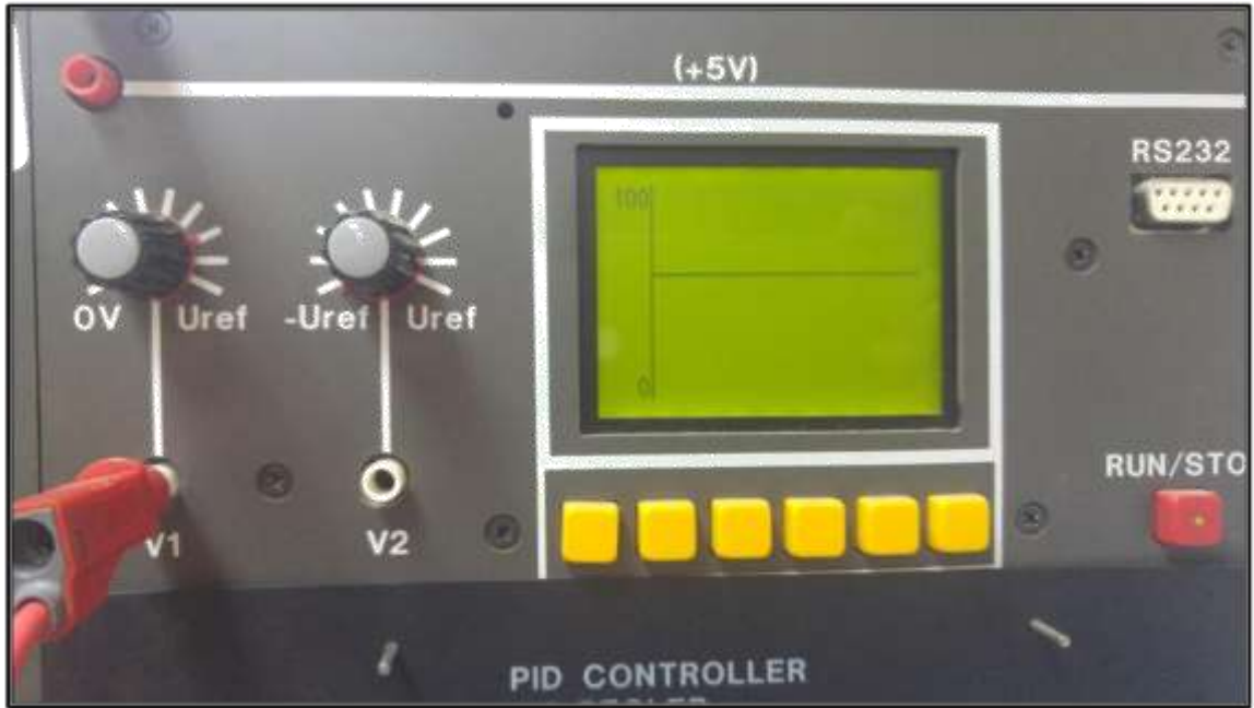
FIGURA N° 30: EL CONTROLADOR PID BUSCA QUE EL PROCESO CONSIGA ESTABILIDAD, ES DECIR REDUCE EL ESTADO TRANSITORIO Y AUMENTA EL ESTADO ESTACIONARIO
