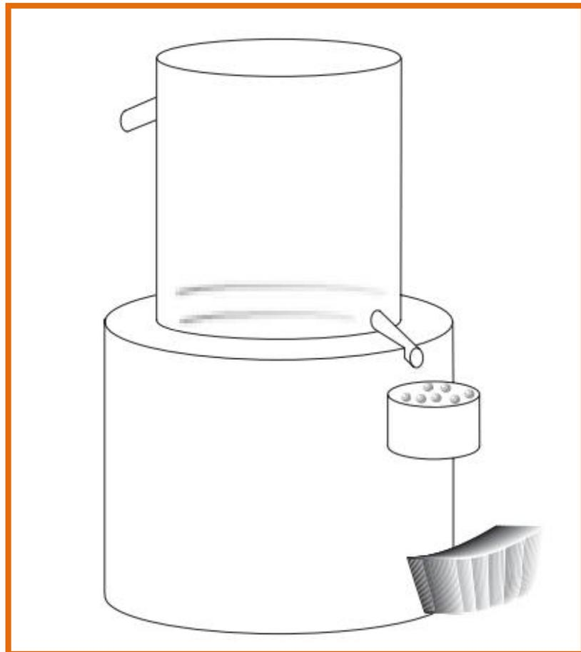
**FIGURA Nº 01: ALARMA DE PLATÓN BASADA EN CLEPSIDRA**
