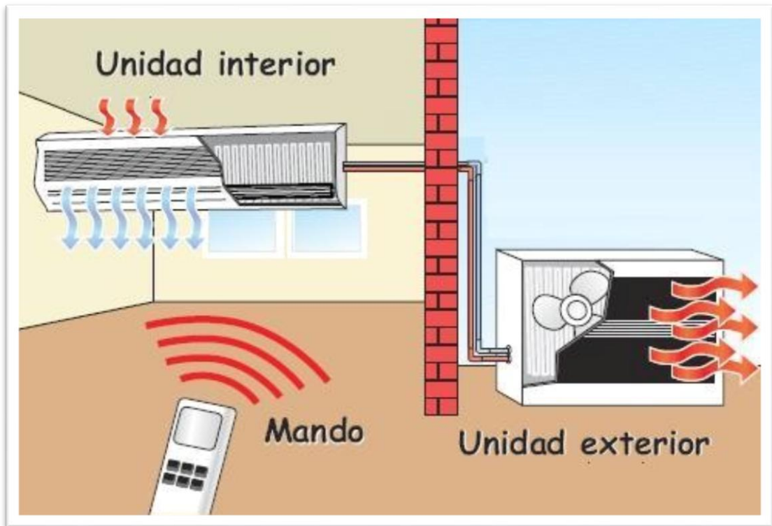
Figura 4. Diagrama de un sistema todo refrigerante
