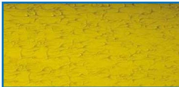
**FIGURA N° 18: AGRIETAMIENTO**
