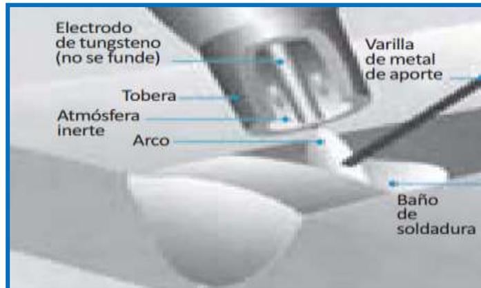
**FIGURA N° 04: PROCESO DE SOLDADURA TIG**
