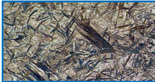
**FIGURA N° 13: MICROESTRUCTURA DE MARTENSITA**
