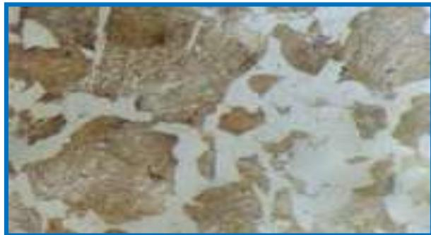
**FIGURA N° 15: FOTOMICROGRAFÍA MOSTRANDO CARBUROS EN RED**
