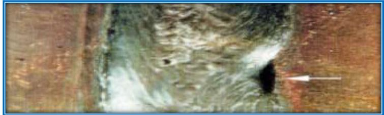
**FIGURA N° 10: FALTA DE FUSIÓN EN LA SUPERFICIE DE LA SOLDADURA**
