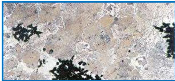
**FIGURA N° 16: FOTOMICROGRAFÍA MOSTRANDO CARBUROS DISPERSOS**
