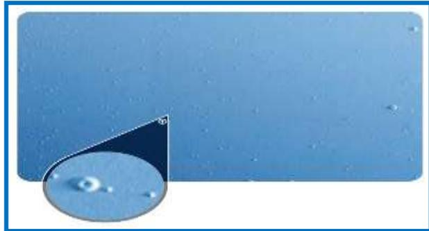
**FIGURA N° 19: PUNTOS DE ALFILER**
