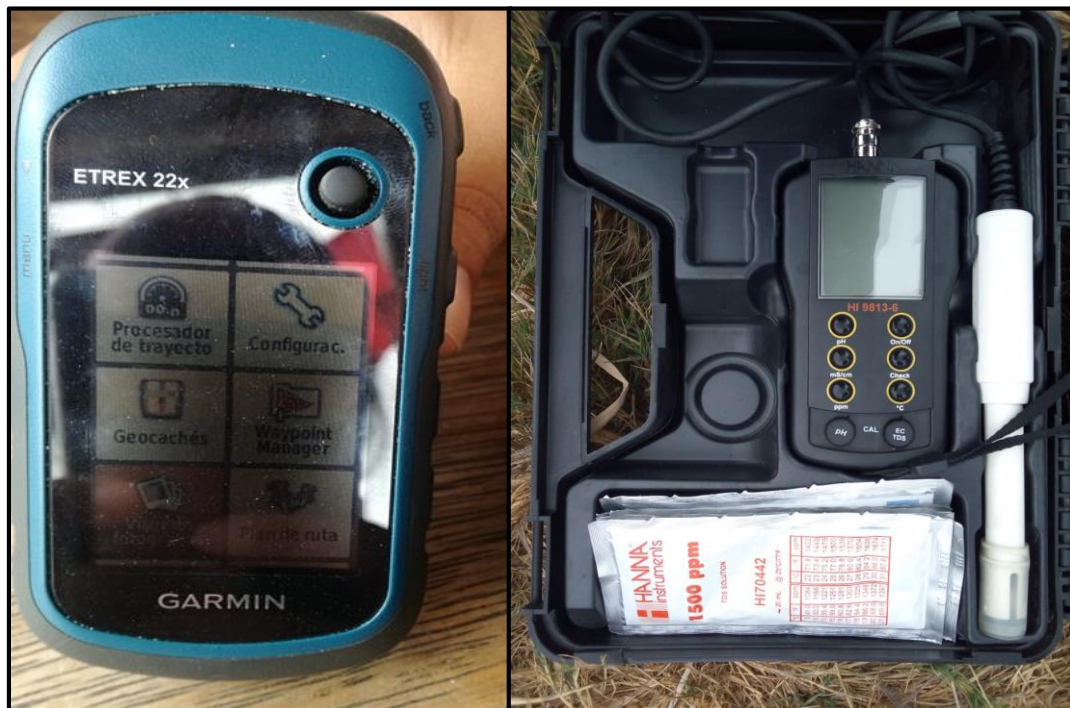
Figura 4. Equipos de campo: GPS Garmin y Multiparámetro HANNA
