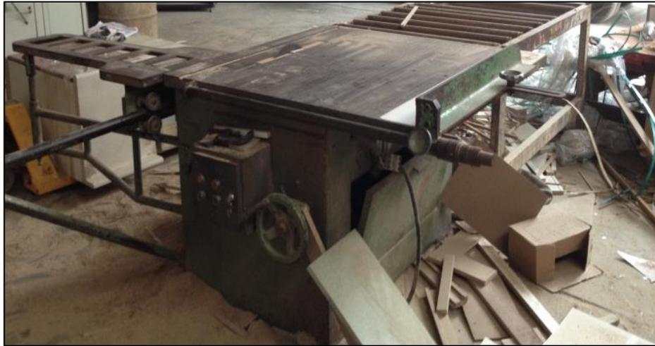
*Figura 14. Maquina Cortadora Circular.*
