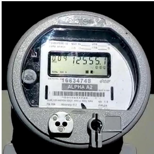
Figura 2: Medidor electrónico marca Elster ALPHA A2 Fuente: Elaboración propia
