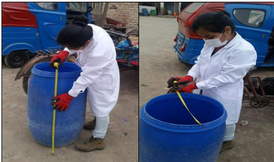
**Figura 6.** Medición de altura total y diámetro del cilindro.
