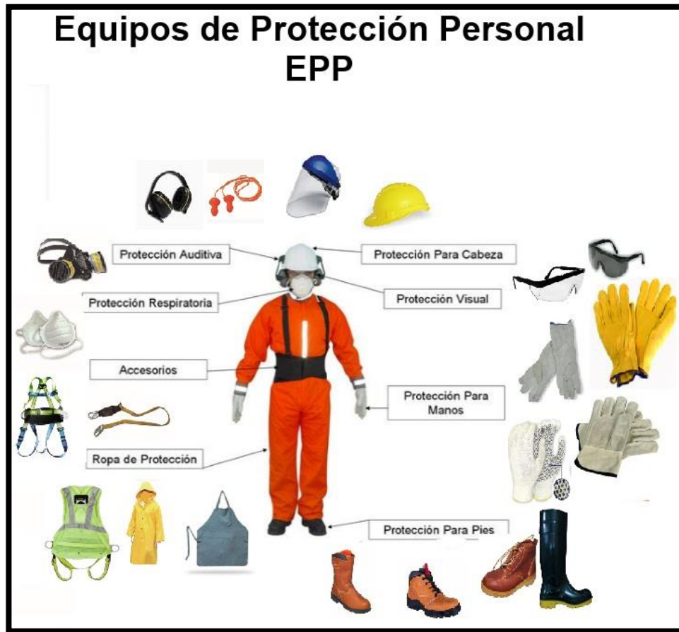
Figura 3.8 Equipos de Protección Personal (EPP)
