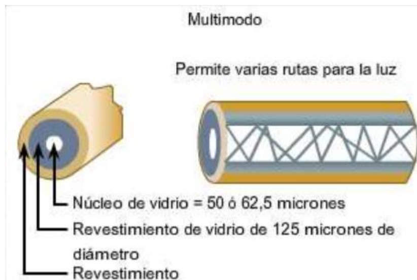
Figura 2.4. Fibra Óptica Multimodal
