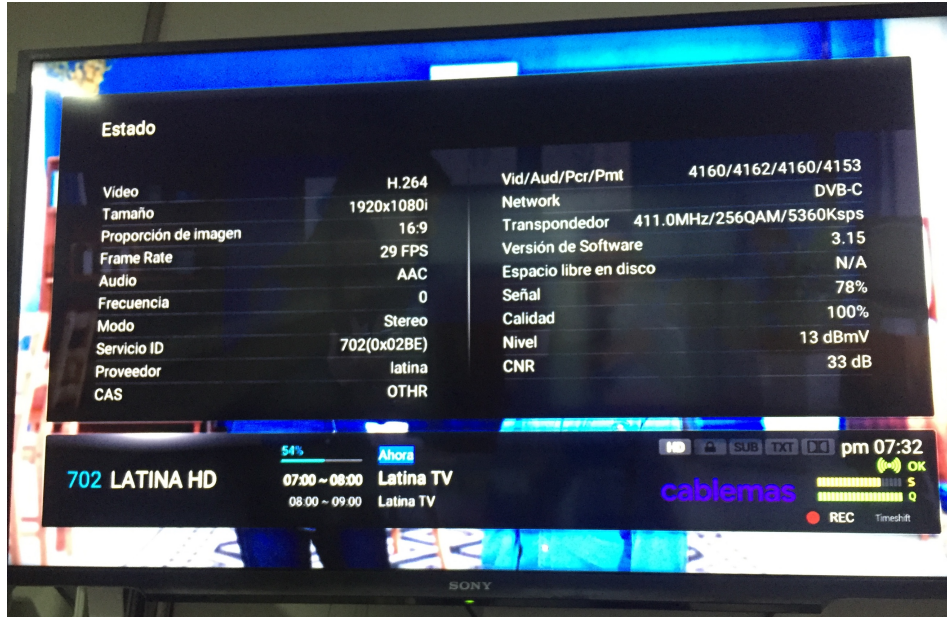
Figura 68: información de transmisión de salida de un canal Fuente elaboración propia
