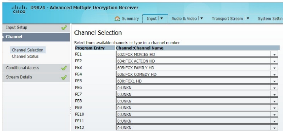
Figura 33: Canales múltiples por portadora Cisco D9824 Fuente: elaboración propia
