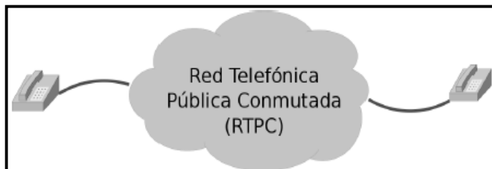
Figura 1: Red Telefónica Pública Conmutada
