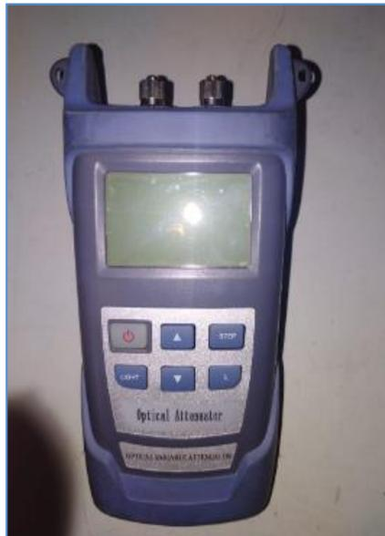
**Figura 3-33.** Atenuador variable digital (Fuente: Elaboración propia)
