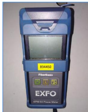
**Figura 3-32.** Medidor de nivel de potencia óptica EXFO EPM-50 (Fuente: Elaboración propia)
