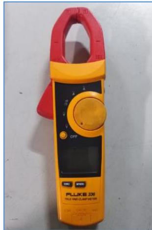
**Figura 3-35.** Pinza Amperimétrica digital FLUKE (Fuente: Elaboración propia)
