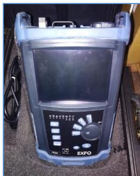
**Figura 3-30.** Analizador de espectro EXFO plataforma FTB-200 (Fuente: Elaboración propia)
