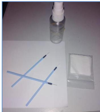
**Figura 3-36.** Conjunto de herramientas de limpieza para fibra y puertos ópticos (Fuente: Elaboración propia)
